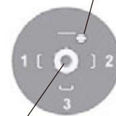
圧力切換点調整 (六角レンチ2mm)
