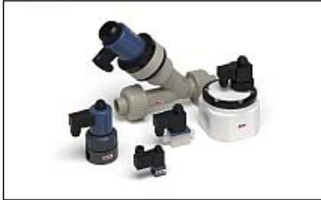
RSGの樹脂製電磁弁では、耐食性が不十分である金属製プランジヤが流体と接触しない様、PTFE ベローズ又はダイヤフラムで仕切られる構造になっています。このため高度の耐食性が確保されます。
